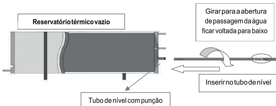
Esquema do reservatório com boia de nível
